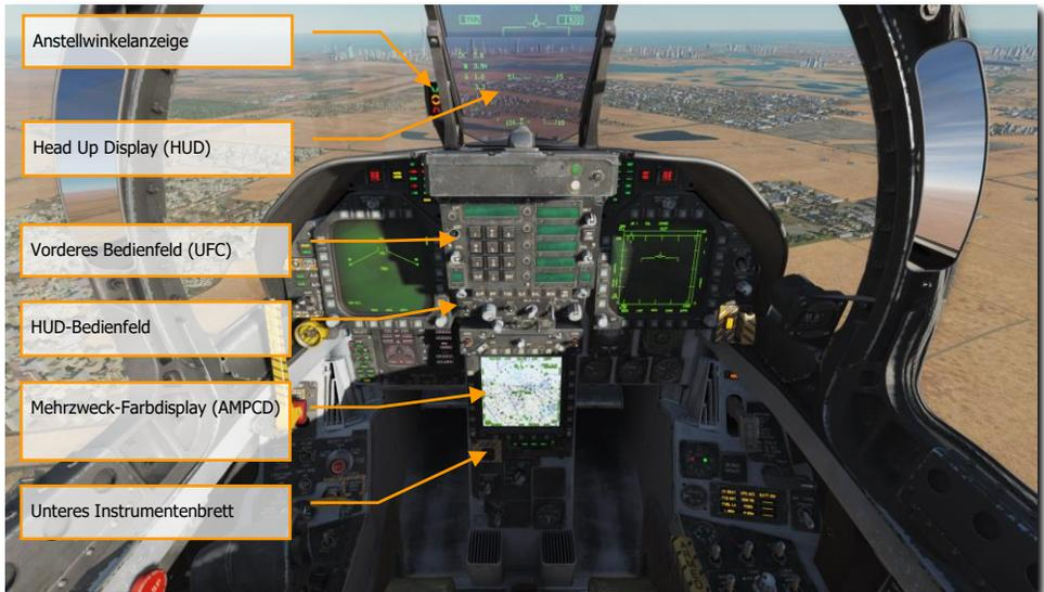
Abbildung 10: Mittleres Instrumentenbrett10
