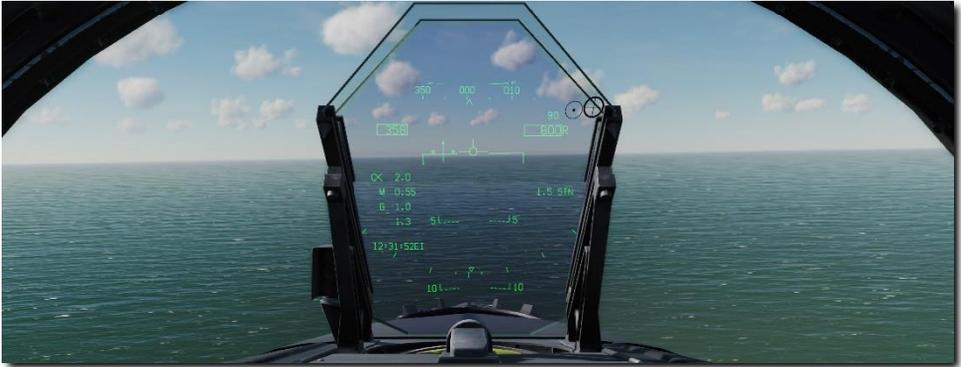
Als Merkhilfe kann diese Kurve mit einer G-Belastung von einem Prozent der Fluggeschwindigkeit geflogen werden. Bei einer Geschwindigkeit von 350 Knoten wären dies 3,5 G. Bei einer Anfangsgeschwindigkeit von über 350 KIAS kann auch die Luftbremse eingesetzt werden, um die Geschwindigkeit unter 250 KIAS zu senken. Sobald die Geschwindigkeit unter 150 KIAS gesunken ist, kann das Fahrwerk **[G]** und die Landeklappen auf FULL ausgefahren werden **[LSTRG + F]**.
