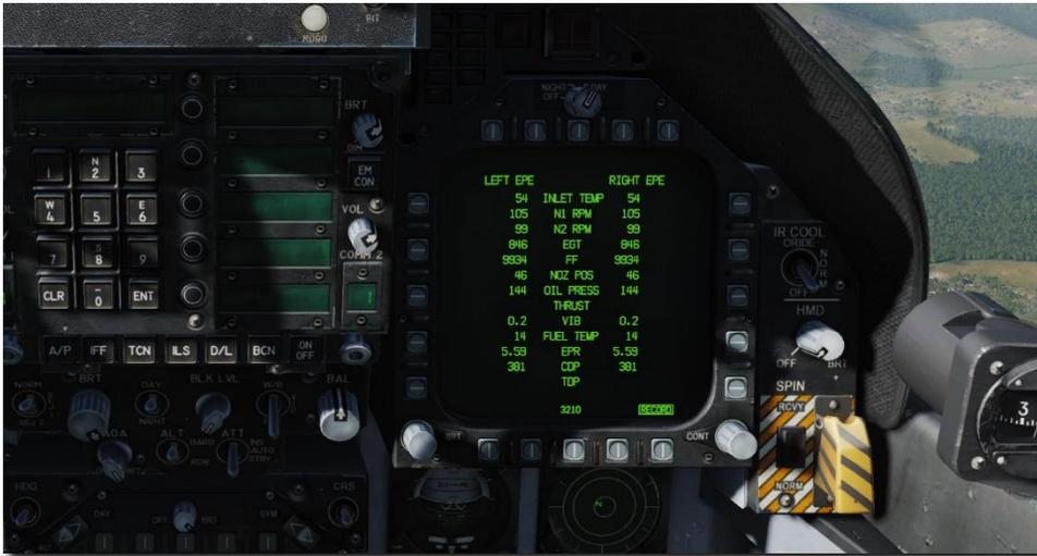
Abbildung 28: Triebwerk-Seite 28
