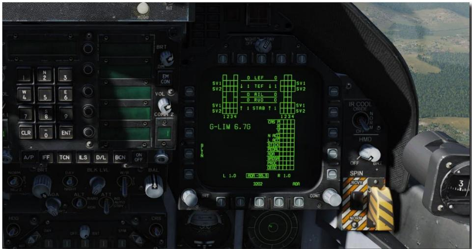
Abbildung 29: Flugsteuersystem-Seite (FCS)29
