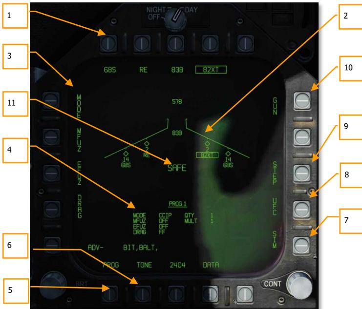
Abbildung 66: Luft-Boden-SMS-Seite für konventionellen Abwurf66
