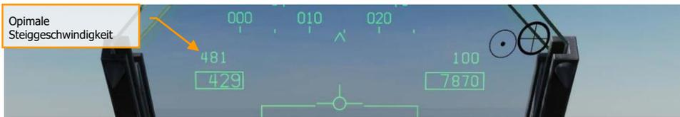
Abbildung 34: Auswahl optimale Steiggeschwindigkeit<sup>34</sup>
