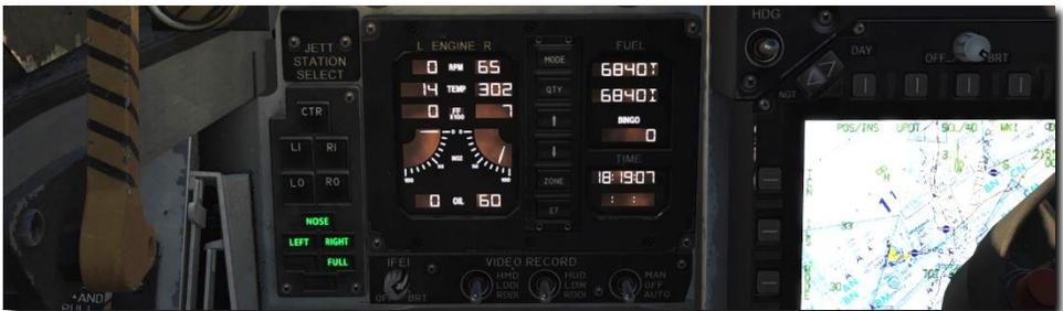
11. Bewegen Sie den linken Schubhebel von der OFF-Stellung in die IDLE-Stellung, sobald die Drehzahl des linken Triebwerks mindestens 25 % beträgt. **[RALT + POS1]** |SCHUBHEBEL|
