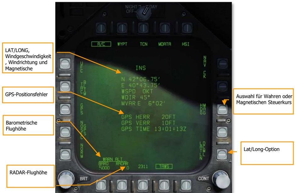
Abbildung 57: HSI-DATA-Unterseite57
