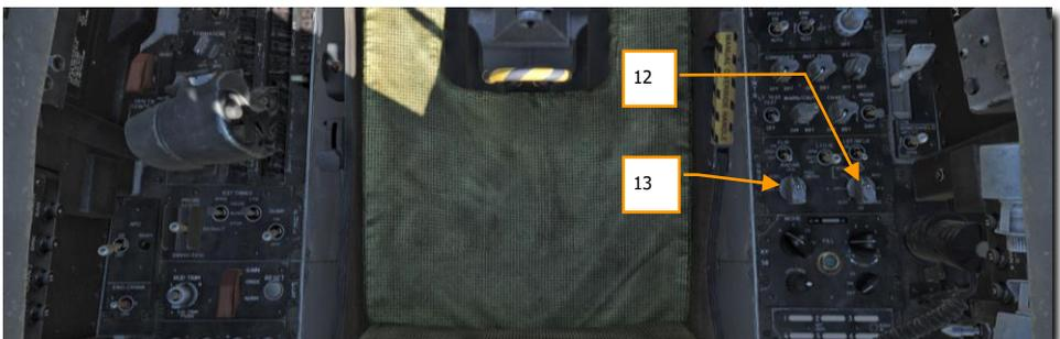
12. Sobald das linke Triebwerk eine Drehzahl von mind. 60 % erreicht hat, Navigationsmodusdrehschalter auf GND (Boden) oder CV (Flugzeugträger) stellen, je nach aktueller Parkposition. |RECHTE KONSOLE|
