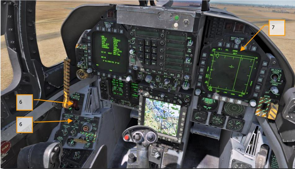
5. Sobald die Abhebegeschwindigkeit des Bugrades erreicht ist, ziehen Sie den Steuerknüppel zurück, bis die Nase 6 - 8 Grad über dem Horizont liegt.
