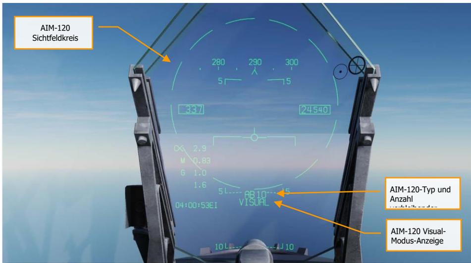
Abbildung 154. HUD der AIM-120 ohne Radaraufschaltung<sup>154</sup>
