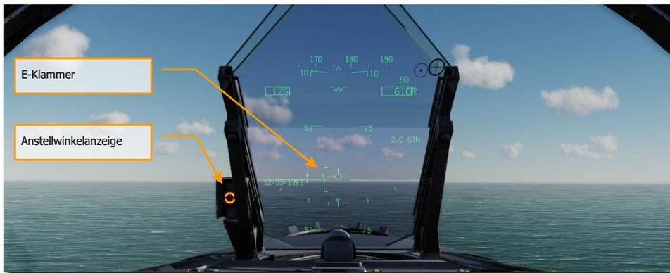
Halten Sie den On-Speed-Anstellwinkel auf 600 Fuß, bis die Rundung am Heck des Trägers sichtbar ist und eine gerade Linie bildet.
