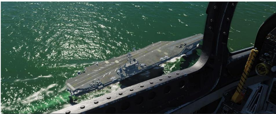
Leiten Sie spätestens 1,5 NM nach dem Überfliegen des Trägers eine Linkskurve ein und halten dabei die Höhe.
