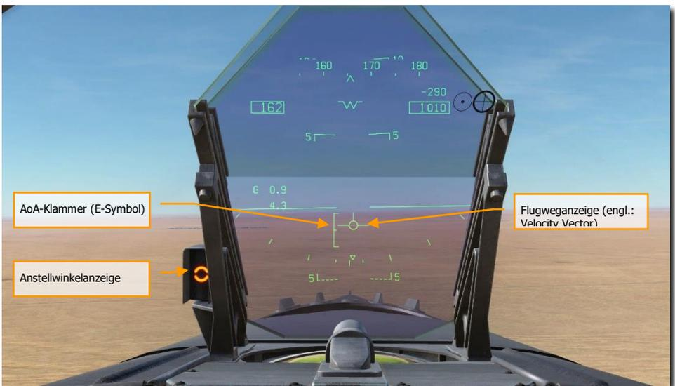
Beginnen Sie die Kurve in den Queranflug (Base), sobald sich die Flügelspitze auf Höhe der Landebahnschwelle befindet. Halten Sie dabei den On-Speed-Anstellwinkel (orangener Kreis). Die Querneigung sollte 30 Grad betragen und die Flugweganzeige sollte sich knapp unter der Horizontlinie im HUD befinden. Halten Sie diese Fluglage und sinken weiter, bis Sie die Landebahn genau vor sich haben.
