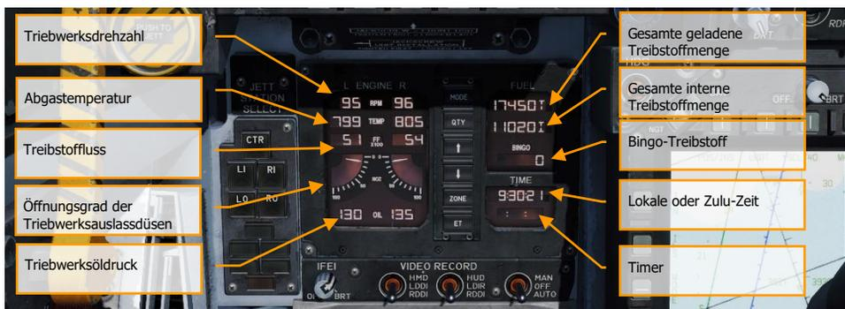
Abbildung 9: Integrierte Anzeige für Treibstoff / Triebwerk (IFEI)9
