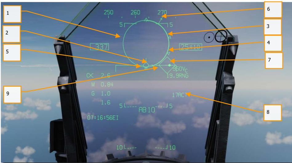
Abbildung 156. AIM-120 HUD mit Radar-Aufschaltung, Zeitpunkt vor dem Abfeuern der Rakete156
