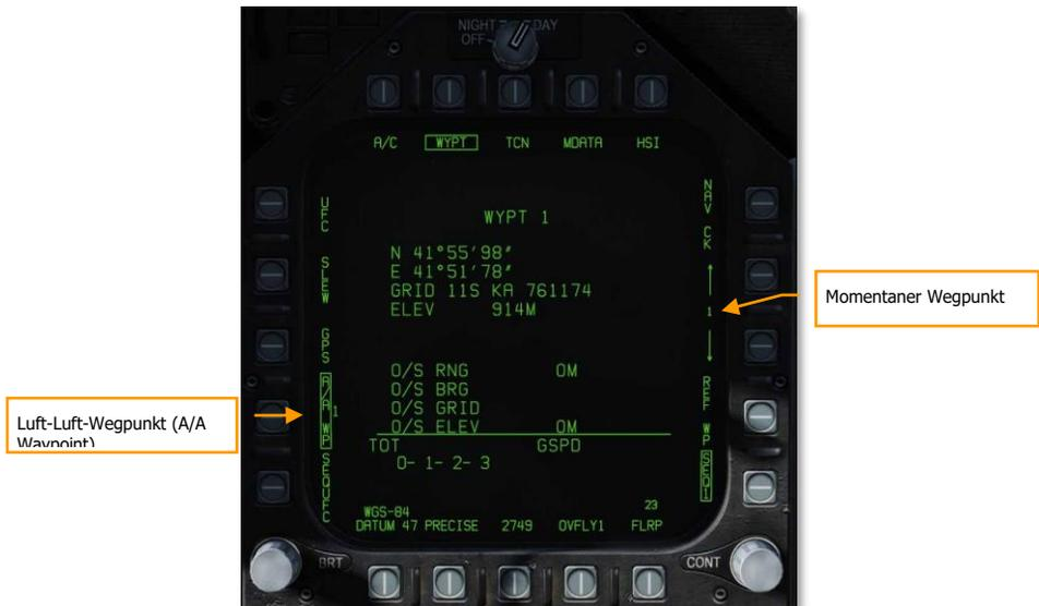
Abbildung 118. Unterseite HSI/DATA/WYPT118
