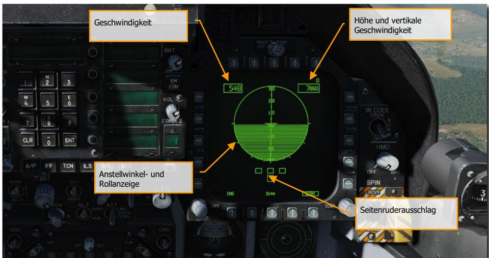
Abbildung 31: Elektronische Fluglageanzeige (EADI)31
