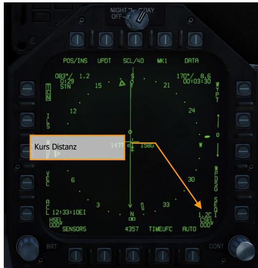
Halten Sie die Höhe von 600 Fuß und lassen Ihre Geschwindigkeit auf etwa 145 KIAS fallen. Erhöhen Sie den Schub aber wieder rechtzeitig, so dass Sie den "On-Speed-Anstellwinkel, dargestellt durch die E-Klammer (E-Bracket) im HUD und die Anstellwinkelanzeige links vom HUD, halten können.
