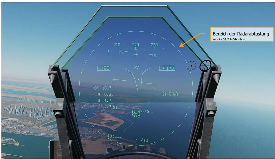
Abbildung 138. Luft-Luft-Kanone, Bereich der automatischen Aufschaltung
