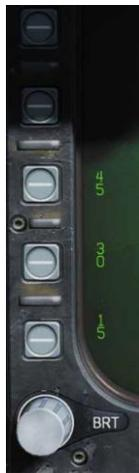
**Missionsauswahl (MSN).** Mit Drucktaste 4 wird die Missionsseite entweder für den PP- oder TOO-Modus angezeigt.
