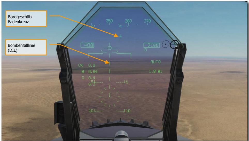
Abbildung 70: HUD-Anzeige im AUTO-Modus, keine Zielmarkierung, <7,5-Grad-Sturzwinkel70
