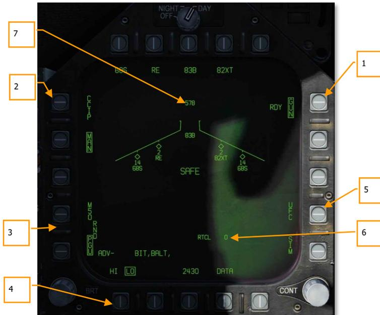
Abbildung 88: SMS-Seite des Luft-Boden-Bordgeschützes88
