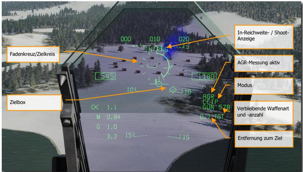
Abbildung 90: HUD des Luft-Boden-Bordgeschützes90
