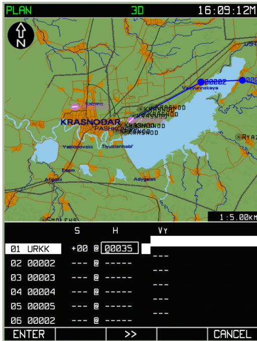
7-51: Eingabe der Flugparameter für den ersten Wegpunkt
