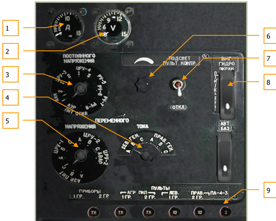
6-71: Bedieneinheit der elektrischen Energieversorgung
