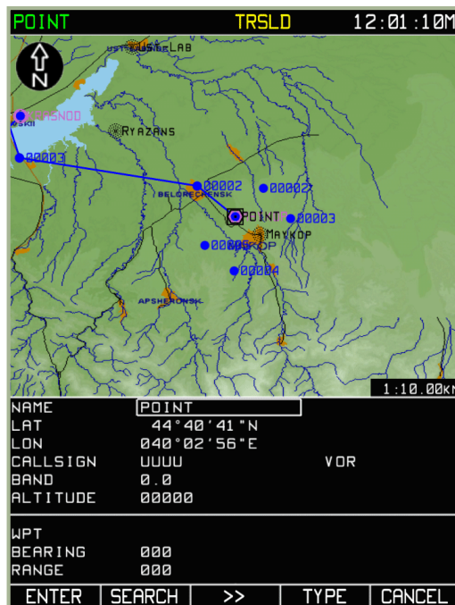
7-84: Auswahl eines Kartenpunkts mit dem TYPE Knopf
