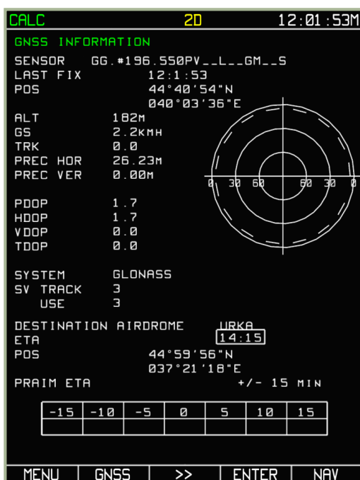
7-106: Datenvorbereitung sowie die Kalkulation für das Flugfeld ANAPA
