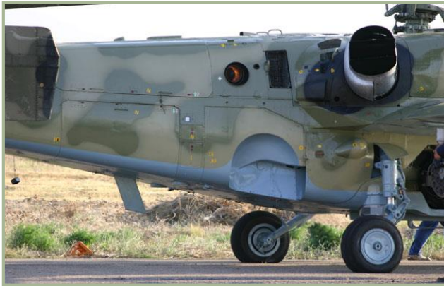
2-3: Abgas-Auslass der APU (in Betrieb) und der schirmartige Abgas-Auslass eines Haupt-Triebwerks
