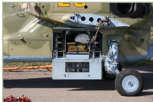
2-2: Hubschrauber mit demontierten Stummelflügel und geöffneter Wartungs-Klappe
