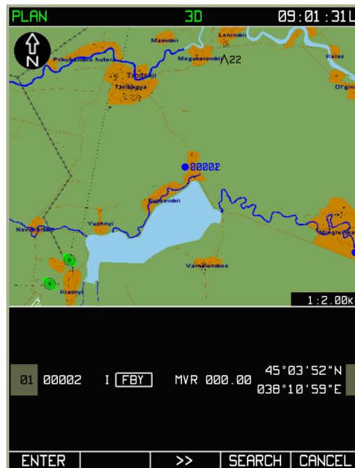
7-35: MENU/PLAN Sub-Modus nach erfolgreicher Suche eines Wegpunkts durch das Suchen eines Wegpunktrufnamens
