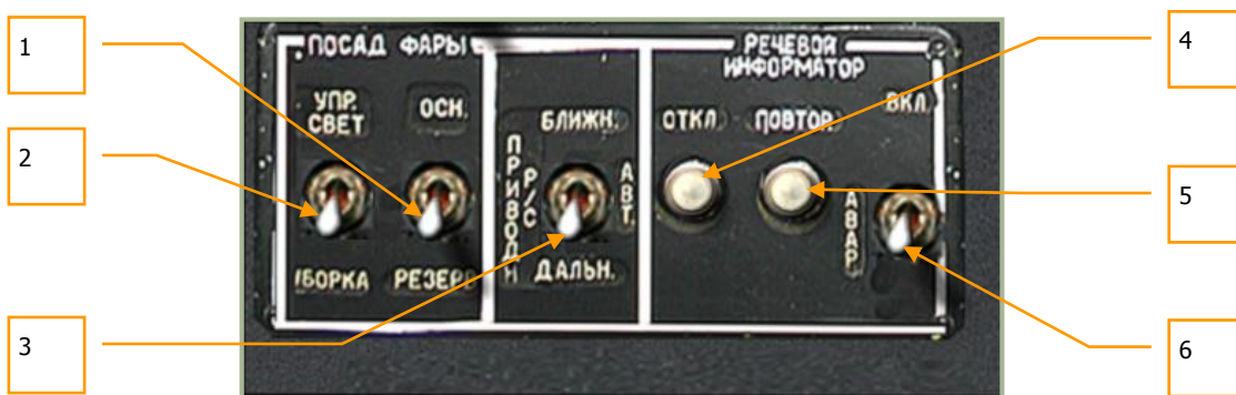
6-41: Panel zur Kontrolle der Landelichter und des Sprachinformationssystems
