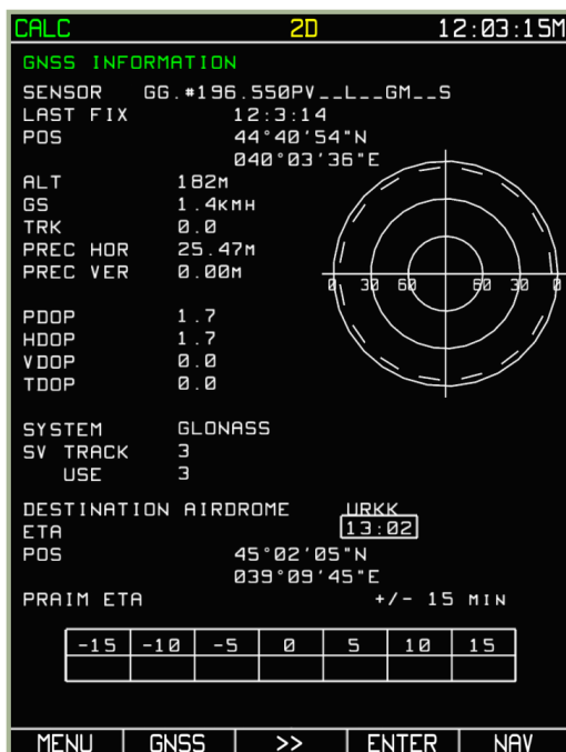
7-104: Automatisierte Datenaufbereitung zur Ansicht des Konstellationsalmanachs sowie zur RAIM Prognose für das Zielflugfeld
