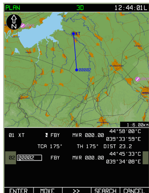
7-40: Einsetzen eines neuen Wegpunkts im MENU/PLAN Sub-Modus
