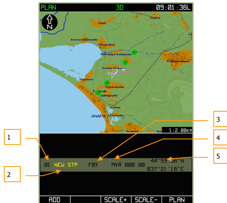
7-29: MENU/PLAN Display beim manuellen Eingeben eines Wegpunkts
