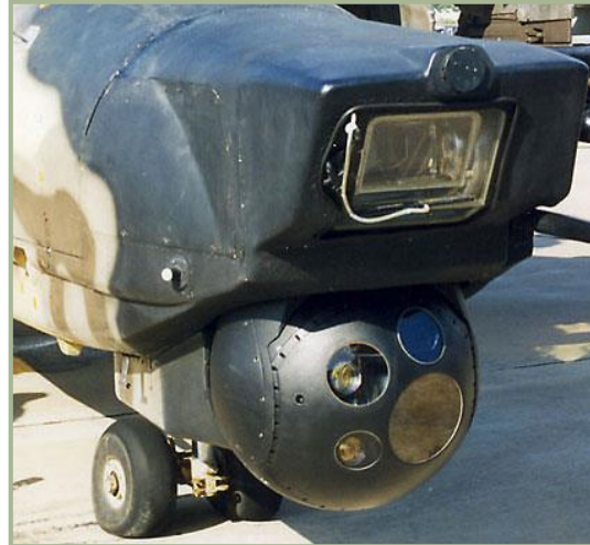
1-12: Ka-50Sh Nase mit dem "Skhval" System oben und dem elektro-optischen Samshit-50 System unten
