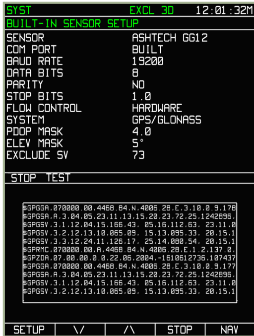
7-101: Die SYST Seite während der Überprüfung des GNSS Sensors und seines Kommunikationskanals
