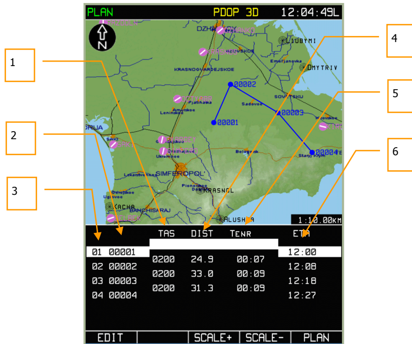
7-45: Eingabe der Abflugzeit sowie der wahren Fluggeschwindigkeit am Abflug-Wegpunkt
