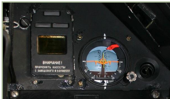
2-5: EKRAN Kontrollsystem (links) und der Ersatz-Fluglagenanzeiger (rechts)
