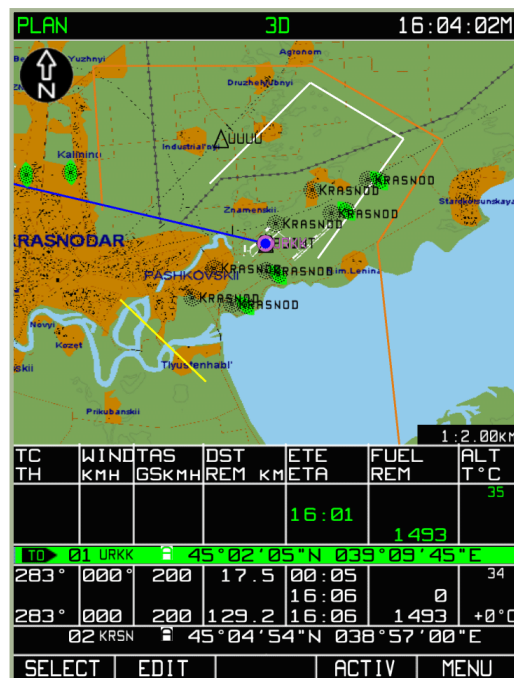
7-66: MENU/PLAN Sub-Modus vor der Aktivierung der Flugroute
