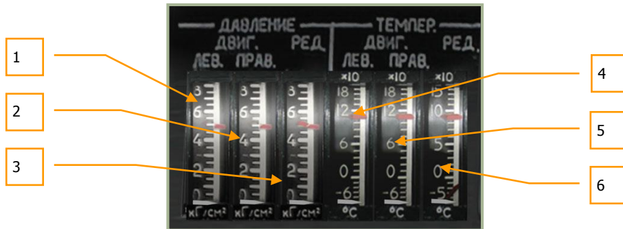
6-57: Anzeigen für Öldruck / Öltemperatur von Getriebe und Triebwerken
