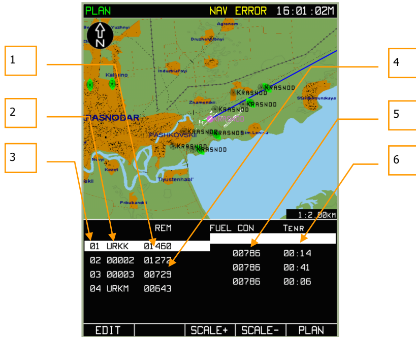
7-62: MENU/PLAN/FUEL Sub-Modus nach Vorgabe der Kraftstoffmenge und des Kraftstoffverbrauchs
