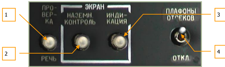
6-67: Bedienpanel des Internen Diagnose- und Warnsystems EKРАН und der ALMAZ Sprachmitteilungseinheit ("Betty") BIT (Build In Test)
