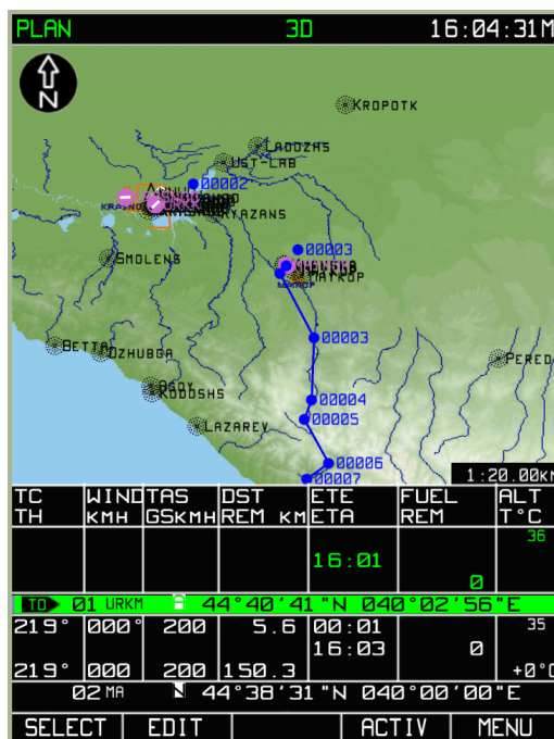
7-69: PLAN Sub-Modus nach dem Laden einer Flugroute
