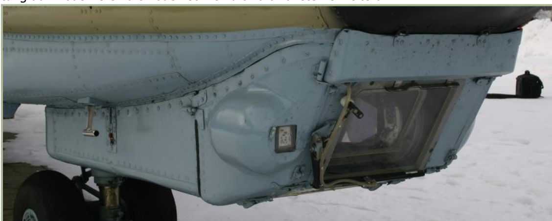
1-7: I-251V "Shkval" automatisches TV Zielerfassungssystem
