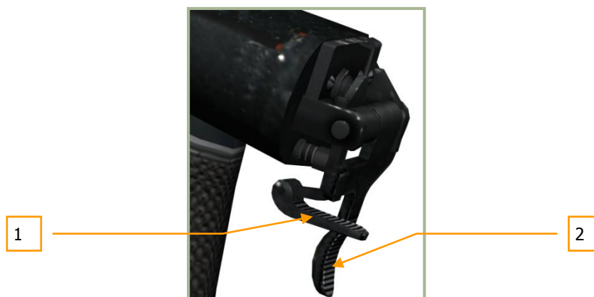
6-5: Waffenauslöseschalter (groß) und Bordkanonen-Feuerknopf (klein) in Normalstellung – Waffenauslöseschalter aktiv
