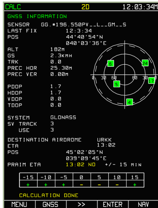
7-104: Automatisierte Datenaufbereitung zur Ansicht des Konstellationsalmanachs sowie zur RAIM Prognose für das Zielflugfeld
