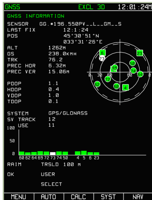
7-101: Die SYST Seite während der Überprüfung des GNSS Sensors und seines Kommunikationskanals
